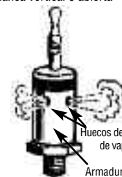
Válvula Control abierto
